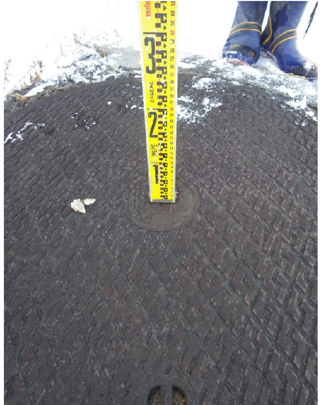
KBM近景 (マンホール天端) H=41.13m
