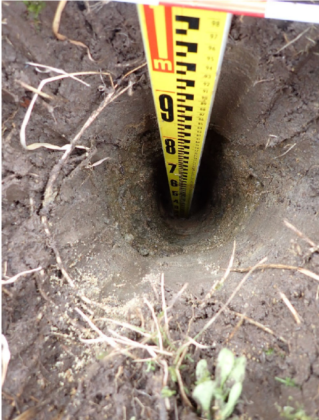
試掘完了 L=1.00m
